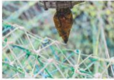
Vom Roboterarm geführt, zieht die Schmelzdüse das Kunststoff-Filament in den Raum.
